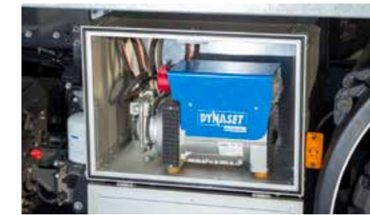
Hydraulikäyttöinen 3-vaihe aggregaatti, 400 V/9,4 A, 230 V/16 A.
