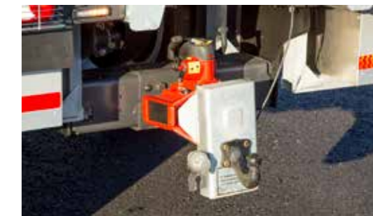
Vetovarustuksena vetokita, sekä 50mm kuula kaapelivaunun vetoon maasto-olosuhteissa.
