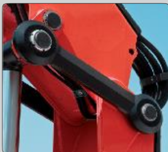
Taotut mekaaniset lenkit nosto- ja taittopuomissa
